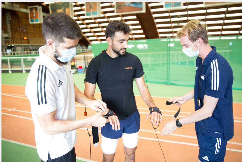
Figure 1 – Installation du système de navigation inertielle « Xsens » sur un participant.
