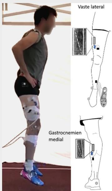
Figure 1 - Vue latérale d'un athlète lors de la réception d'un saut en contrebas à deux jambes (à gauche) avec représentation schématique des outils utilisés (échographie ultra-rapide, capteurs de pression, électromyographie de surface et analyse cinématique) (à droite).
